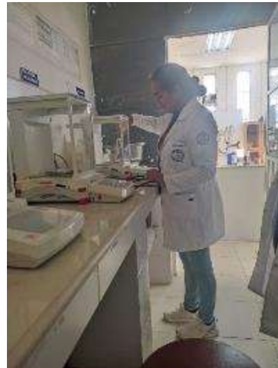
Medición de la humedad
