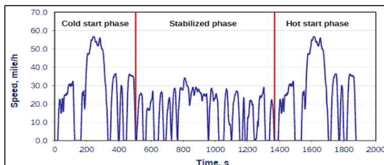
Ilustración 2-22: Programa de conducción urbano de la EPA de EE. UU. (FTP-75)
