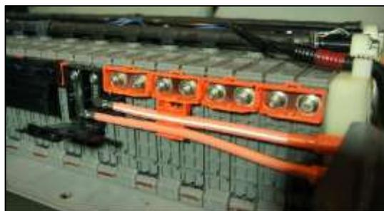
**Ilustración 2-29:** Pack de baterías de Ni-MH
