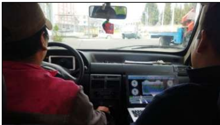
Ilustración 3-26: Calibración de la ECU MS3 en circuito urbano
