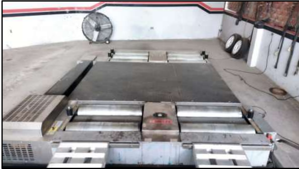
Ilustración 2-18: Dinamómetro de cachis de doble rodillo Dynocom DC500-FX.
