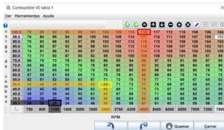
Ilustración 4-4: Cartograma tiempo de inyección de combustible
