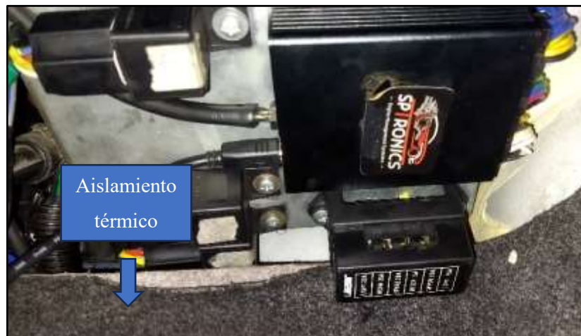
Ilustración 3-14: Ubicación del soporte de la ECU MS3 en el vehículo.
