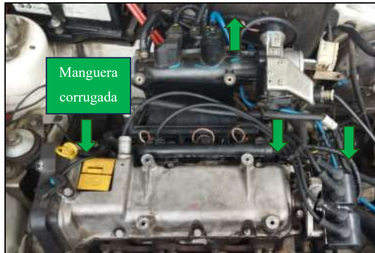
Ilustración 3-12: Conexión final de la nueva red de cableado.
