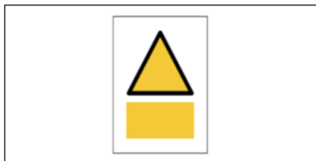
Ilustración 4-7: Diseño para una señal combinada con una señal complementaria debajo de una señal de seguridad.
