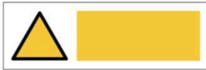
Ilustración 2-9: Diseño para una señal combinada con una señal complementaria a la derecha de una señal de seguridad.
