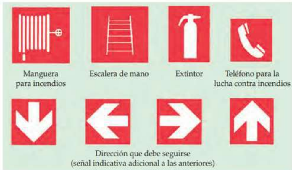
Ilustración 4-15: Señales correspondientes a equipos contra incendios.
