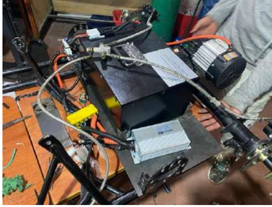
Ilustración 3-22: Conexión de la batería con el motor y otros componentes.
