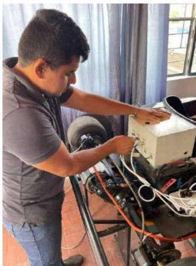
Ilustración 3-23: Conexión de los sensores al Datalogger.
