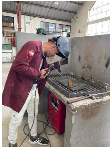
Ilustración 3-21: Soldadura de acoples en la base para la batería.
