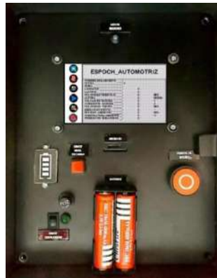
Ilustración 4-2: Instrumento de recolección de datos de consumo (Datalogger)
