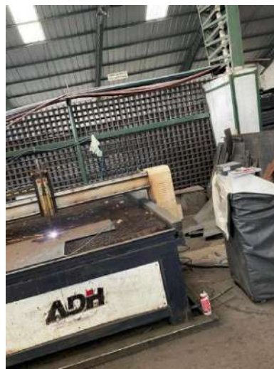
Ilustración 3-19: Cortadora CNC cortando la base
