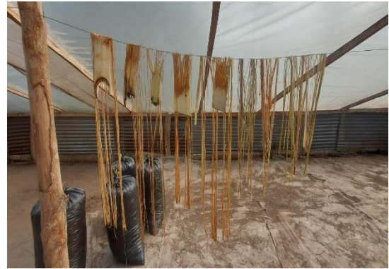
2. Obtención de la fibra de pseudotallo de plátano
