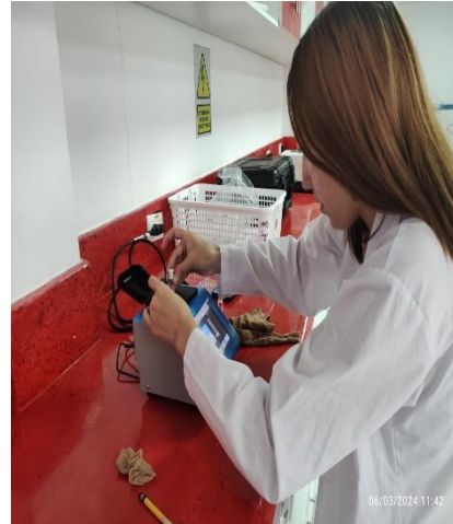
14. Medición de hidrocarburos del agua
