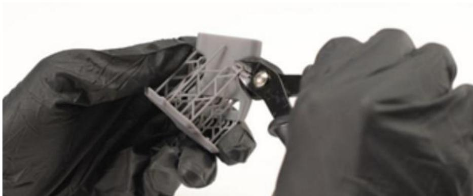
**Figura 24-2.** Extracción flexionando la cama (cama flexible).
