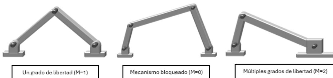
**Figura 16-2.** Mecanismos y estructuras con movilidad variable.
