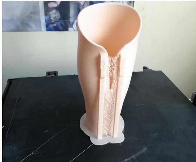
**Figura 48-3.** Socket impreso en 3D material TPU.
