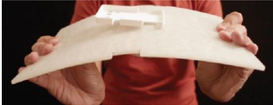
**Figura 23-2.** Extracción flexionando la cama (cama flexible).
