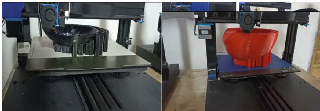
Figura 58-3 Proceso de impresión de los cascos en materiales ABS y PLA.
