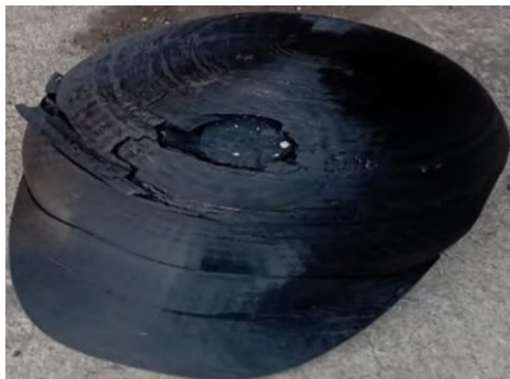
Figura 2-4 Casco con material ABS después de las pruebas de absorción de impacto
