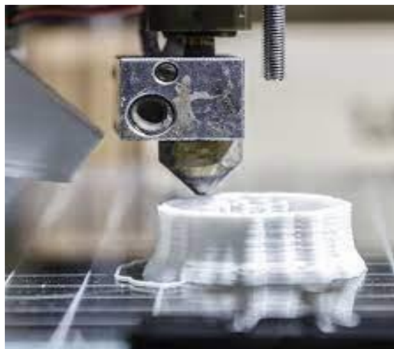
Figura 9-2 Proceso de impresión 3D de un polímero
