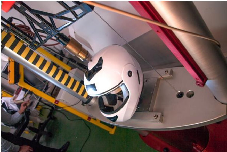
Figura 13-2 Ensayo de adsorción de impactos en cascos de motociclistas
