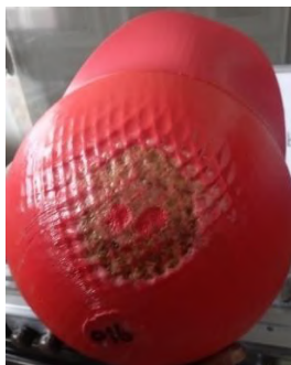
Figura 4-4 Casco con material PLA después de la prueba de inflamabilidad
