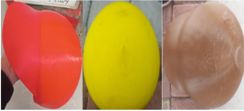
Figura 3-4 Cascos de material PLA después de las pruebas de absorción de impacto
