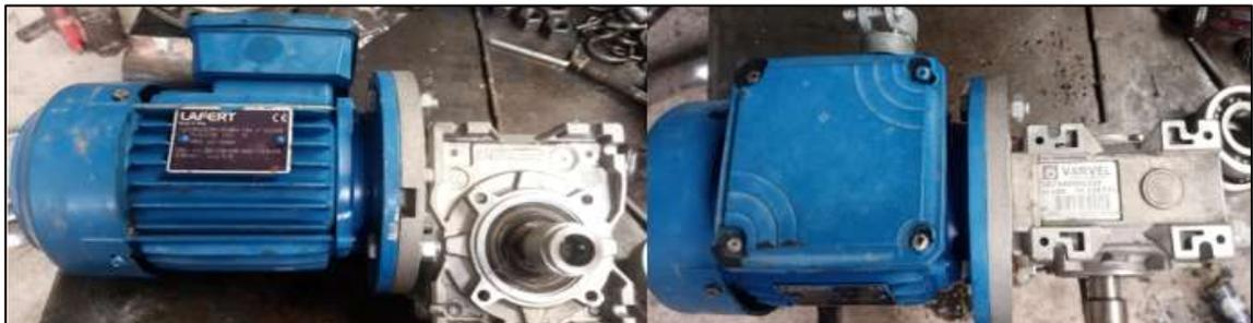
**Ilustración 3-4:** Motor LAFERT para operación de desplazamiento.
