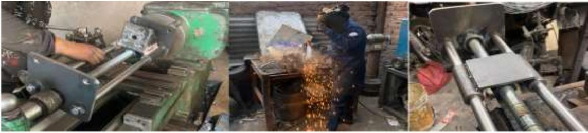
**Ilustración 3-56:** Construcción del mecanismo de desplazamiento.
