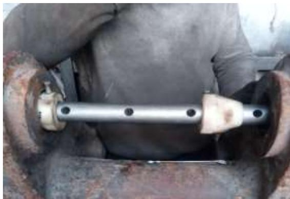
**Ilustración 4-1:** Colocación de los conos centradores.
