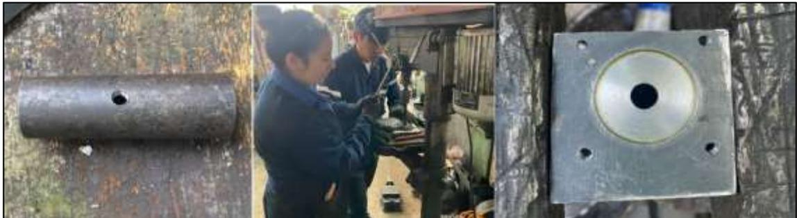
**Ilustración 3-55:** Proceso de construcción de las bases para motores.
