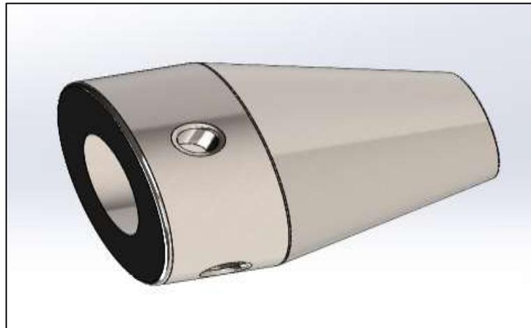
**Ilustración 3-39:** Diseño del cono centrador.
