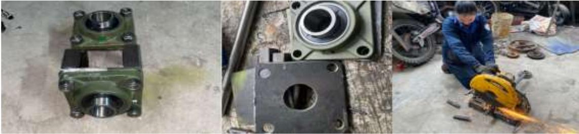
**Ilustración 3-58:** Construcción de las bases para chumaceras.
