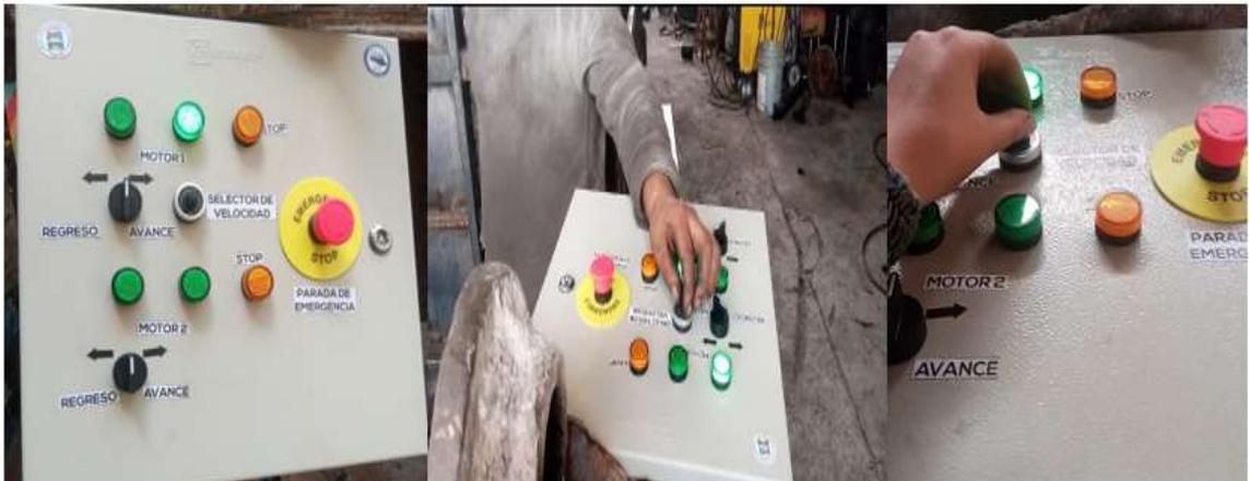
**Ilustración 4-8:** Prueba de arranque en el tablero
