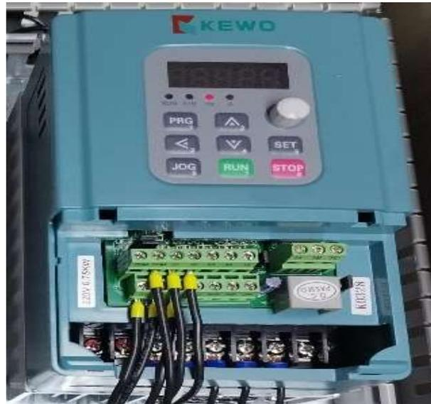
**Ilustración 3-3:** Variador de frecuencia para operación de corte.
