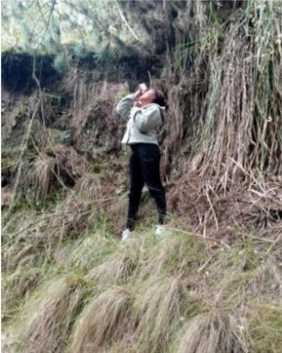
**Ilustración 3-3:** Estimación de las alturas con el clinómetro SUNNTO
