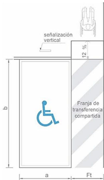
Ilustración 2-2: Señalización horizontal para plazas de estacionamiento para personas con discapacidad y movilidad reducida
