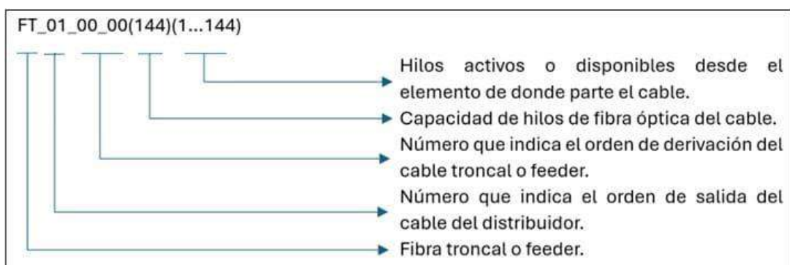
Ilustración 3-15: Nomenclatura del cable Feeder.
