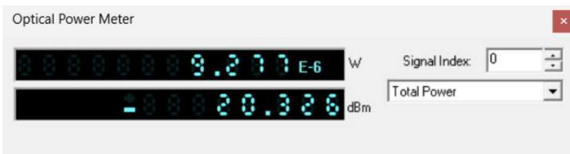
Ilustración 4-7: Potencia recibida a la ONT del usuario más cercano
