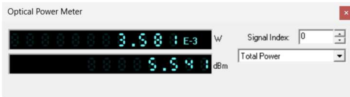
Ilustración 4-6: Potencia suministrada por la OLT.
