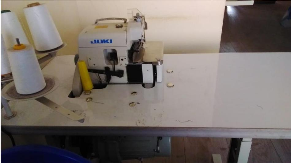
**Ilustración 0-7:** Máquina Overlock 4 Hilos
