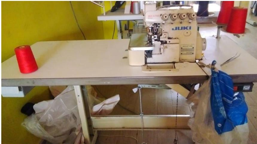
**Ilustración 0-2:** Máquina Overlock 5 hilos
