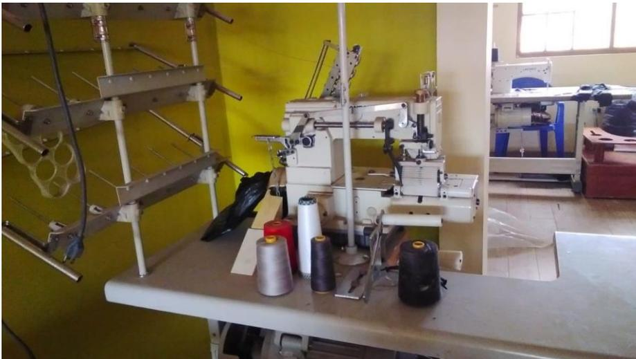
**Ilustración 0-4: Máquina Elasticadora**
