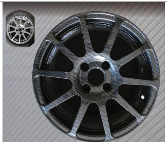
C2. Pintura transferida a un aro de llanta
