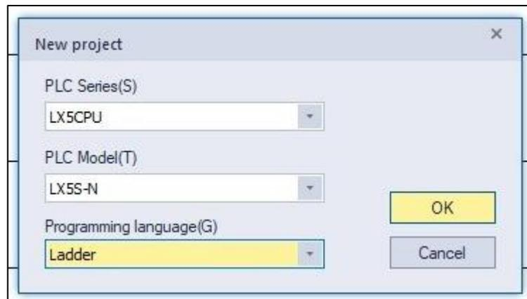
**Ilustración 3-24.** Selección del modelo del PLC LX5S-N
