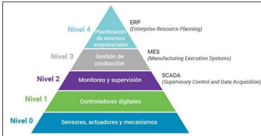
**Ilustración 2-1. Estructura piramidal de la Automatización**
