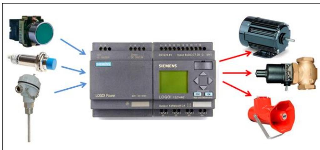
**Ilustración 2-4. PLC y sus diferentes usos**
