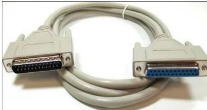
**Ilustración 3-8.** Cable de comunicación DB25-MG6
