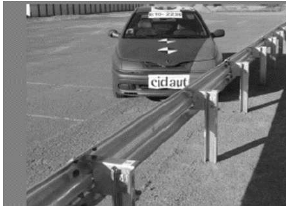
Ilustración 2-10: Pruebas de impacto a escala real
