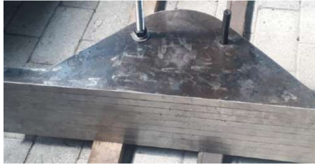
Ilustración 3-41: Ensamble final de la cara de impactador.
