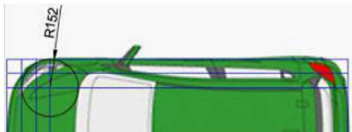
Ilustración 3-10: Radio de curvatura de la cara del impactador
