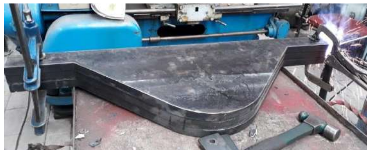
Ilustración 3-40: Figuras tipo impactador soldadas en su arista.
