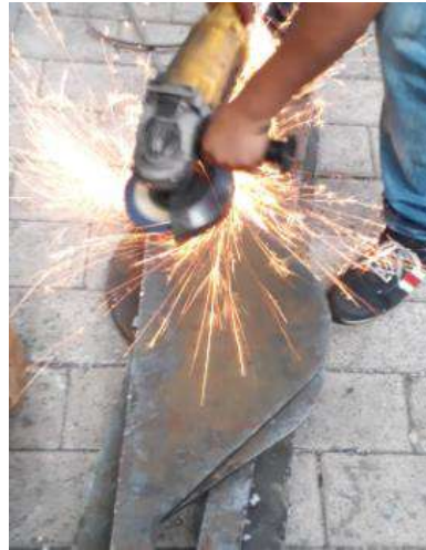
Ilustración 3-37: Desbaste de las imperfecciones.
