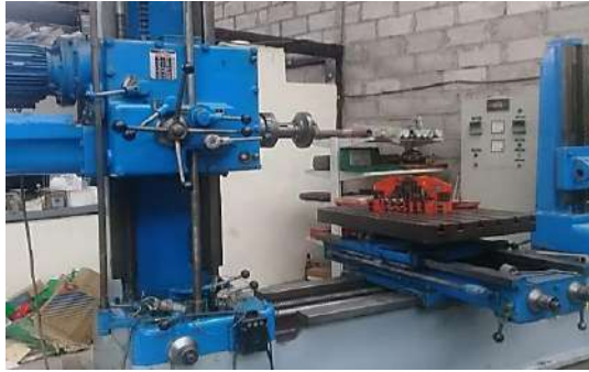
Ilustración 2-26: Mandrinadora para de mecaniza
