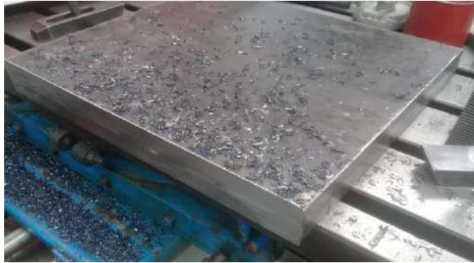
Ilustración 3-43: Mecanizado de las aristas de la pared del cubo.
