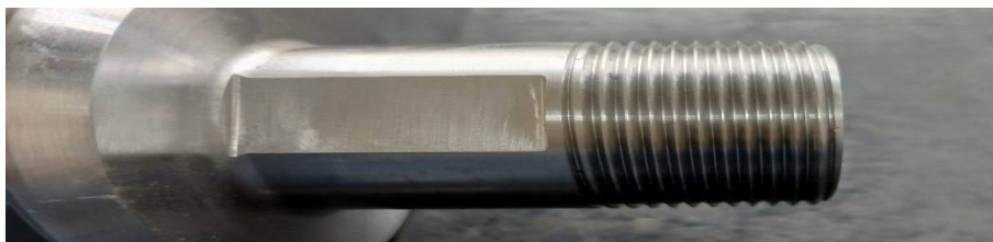
Ilustración 2-4: Conexión tipo API
