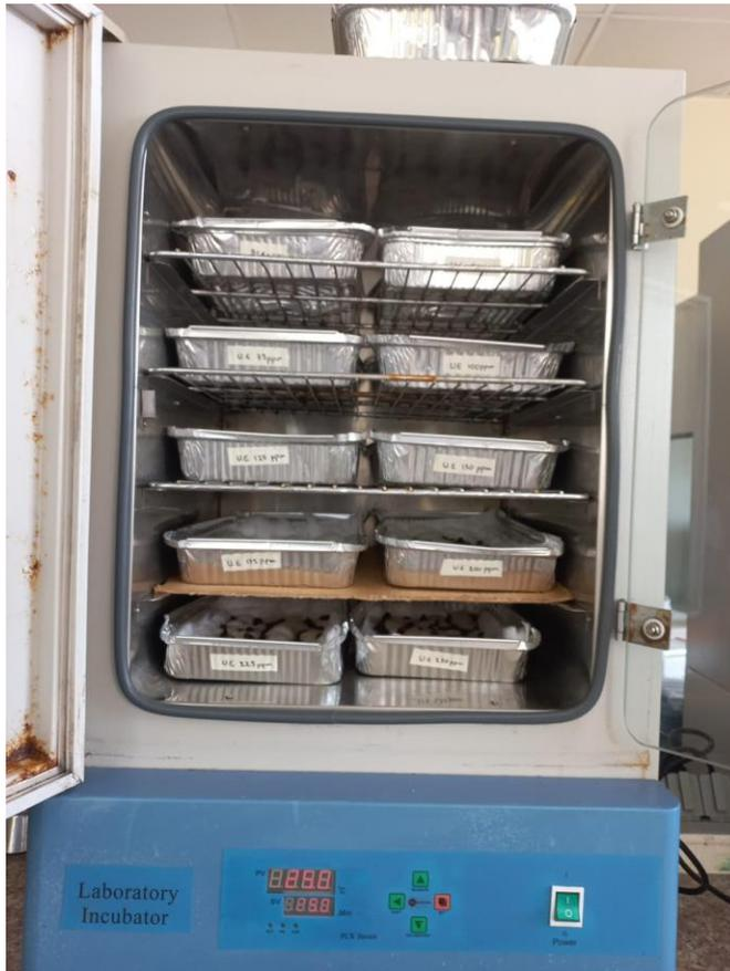
**Ilustración 3-8:** Bandejas de aluminio ubicadas en la incubadora a 25 °C
