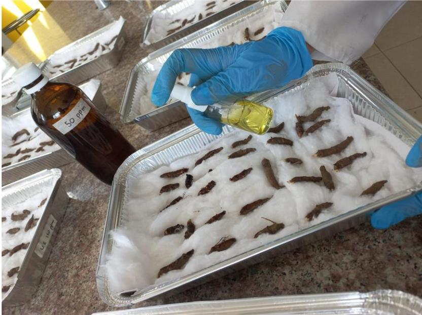
**Ilustración 3-5:** Riego con Dicromato de potasio en cada una de las bandejas de aluminio
