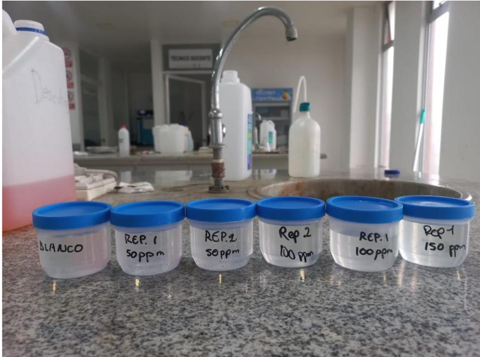
**MUESTRAS LISTAS PARA SER ANALIZADAS EN EL ESPECTROFOTÓMETRO**
