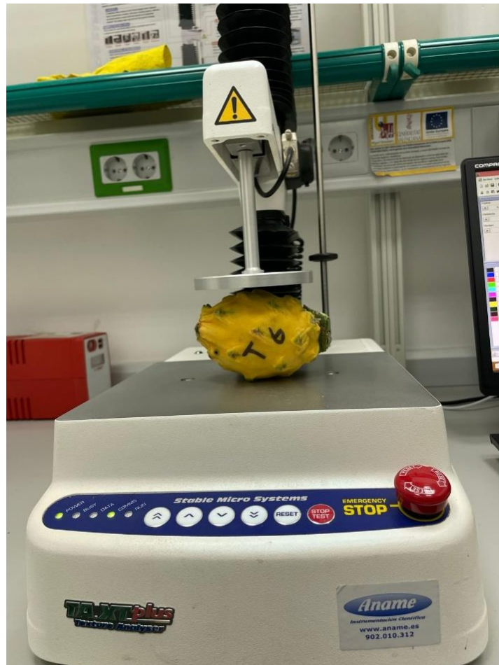
Ilustración 3-5: Texturómetro para medir la firmeza del fruto
