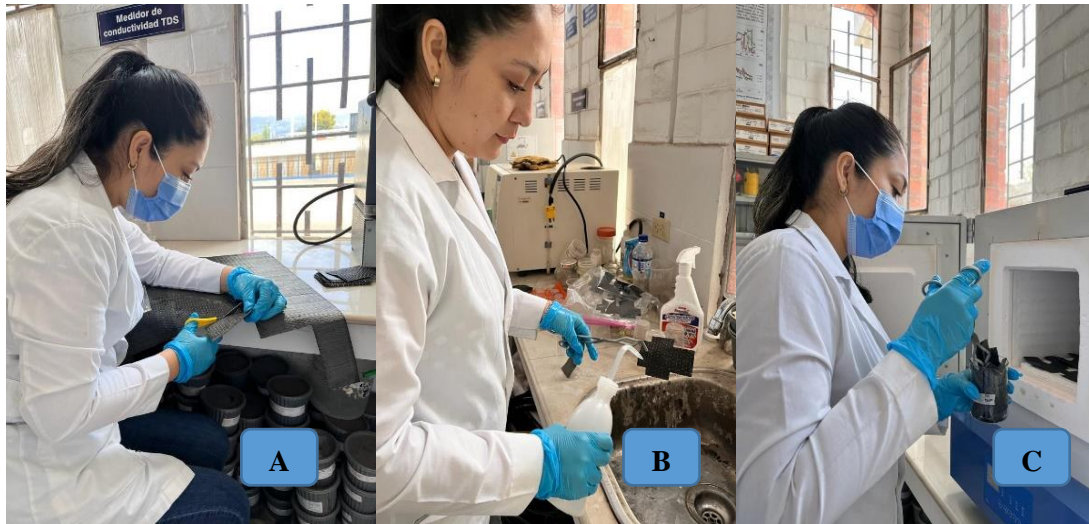
Ilustración 9-3. Tratamiento de membranas A: Recorte de membranas. B: Lavado de membranas. C: Secado de membranas anódicas.
