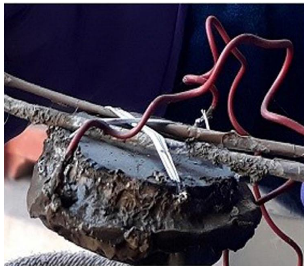
Ilustración 3-2. Membrana a base de almidón.
