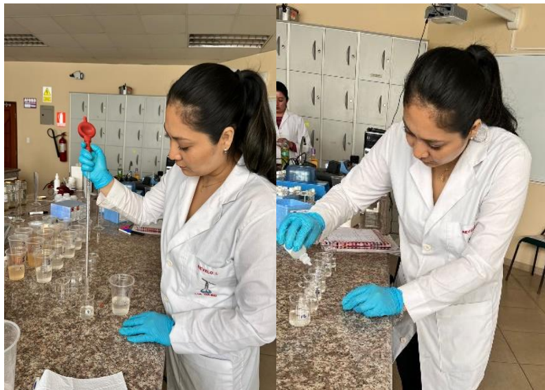
Ilustración 12-3. A: Incorporación del estabilizador mineral y del agente dispersante de alcohol de polivinilo. B: Reactivo Nessler.
