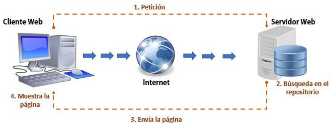
Figura 1-2: Esquema básico del funcionamiento de una aplicación web
