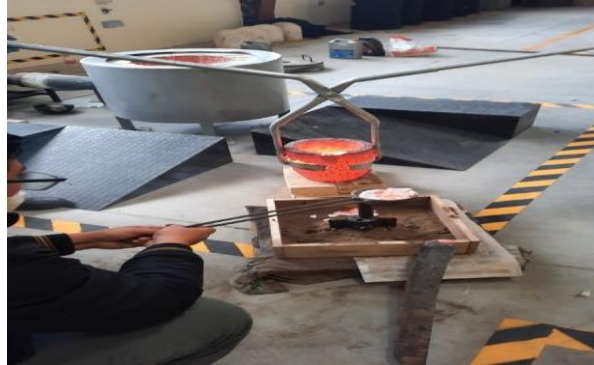
Ilustración 4-7: Vertido de la colada en el molde dentro de la caja con arcilla.
