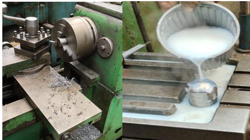
Ilustración 3-36: Proceso de corte del eje sobrante del molde.
