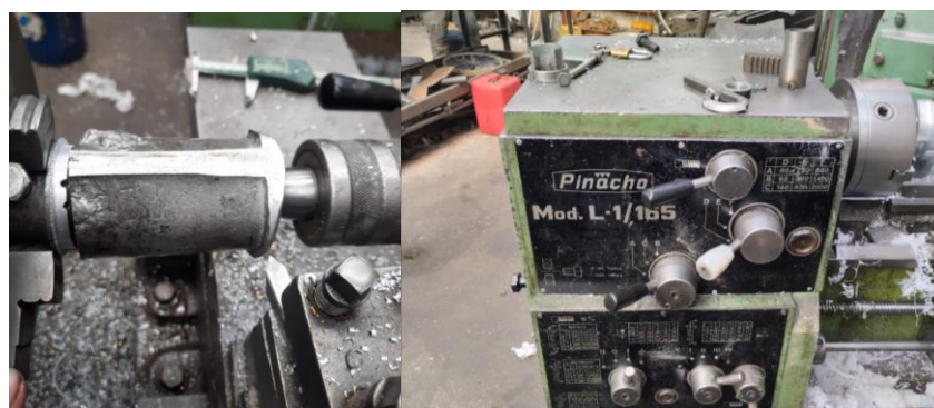
Ilustración 4-10: Mecanizado del pistón con cilindrado y refrentado.
