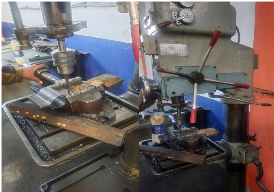
Ilustración 3-39: Perforación de las placas laterales con taladro de pedestal.
