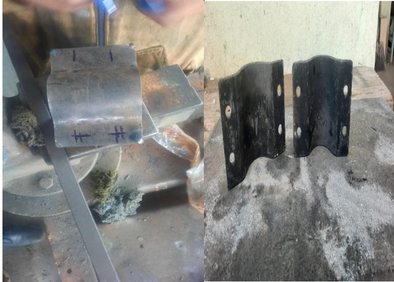
Ilustración 3-38: Marcado de los agujeros de los soportes laterales.
