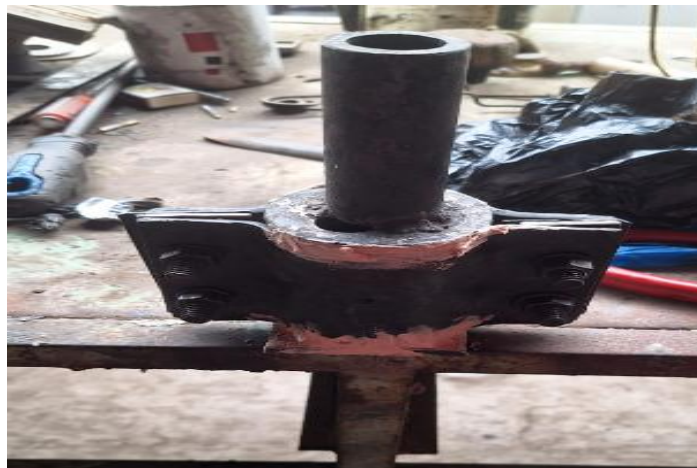
Ilustración 4-3: Ajuste de hermeticidad del molde por torque y sellado con masilla y arcilla.
