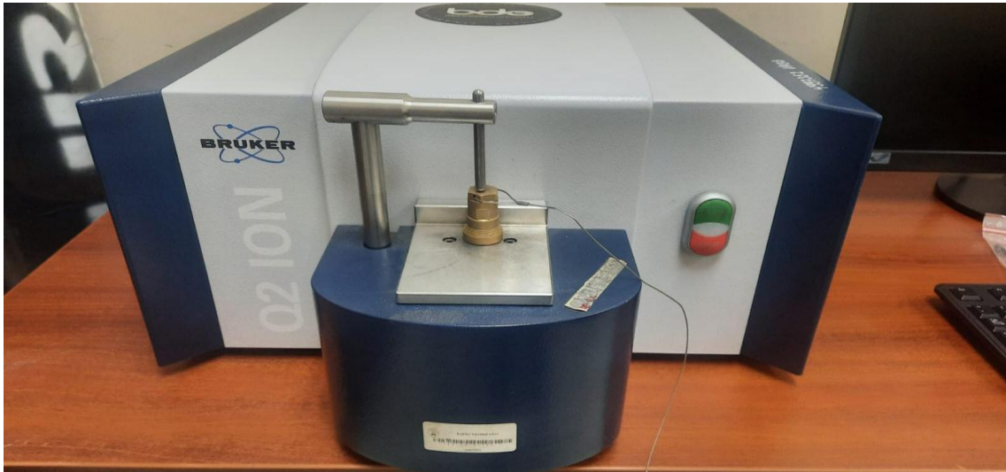
Ilustración 3-2: Análisis de espectrometría de aceros al carbono ASTM E415.
