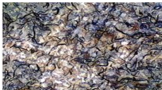
Ilustración 2-2: Fundiciones grises con estructura totalmente perlítica.
