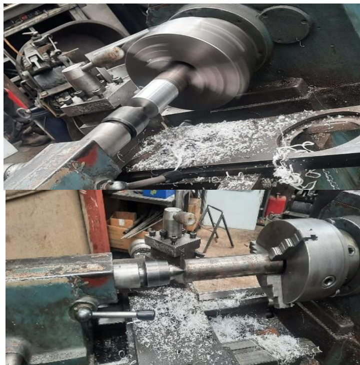
Ilustración 3-31: Mecanizado del eje de 2" del pistón de 100cc.
