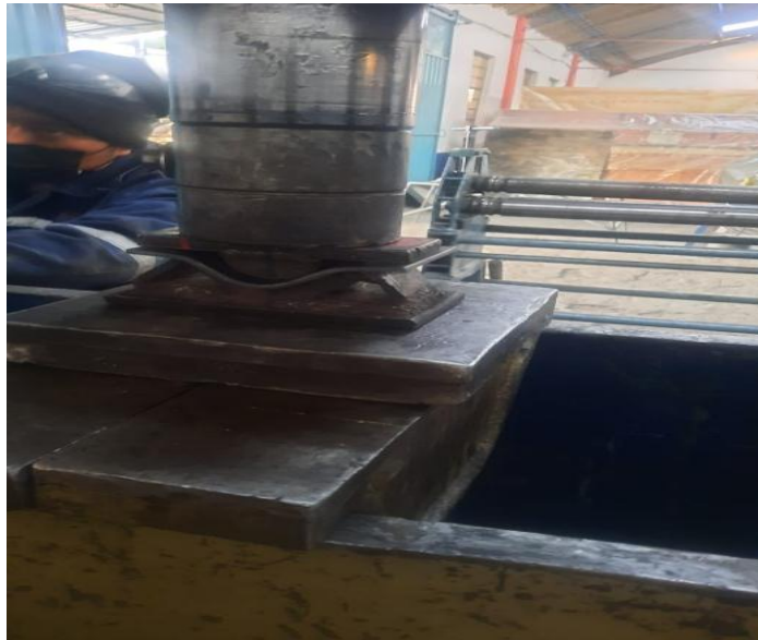
Ilustración 3-37: Proceso de doblado de los soportes laterales.
