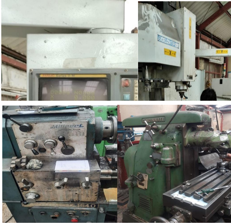
Ilustración 3-12: Ilustración de equipos Fresa CNC FANUC Series O-M y Torno.
