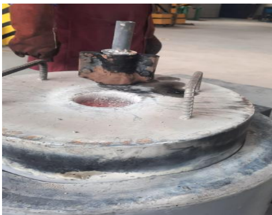
Ilustración 4-5: Ajuste de hermeticidad del molde por torque y sellado con masilla y arcilla.
