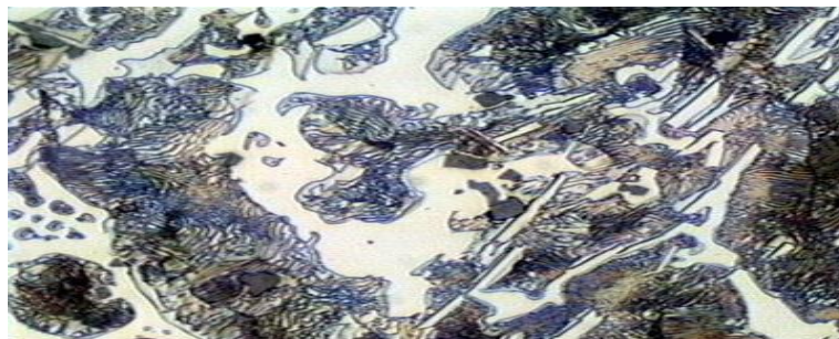
Ilustración 2-1 Microestructura típica de las fundiciones blancas
