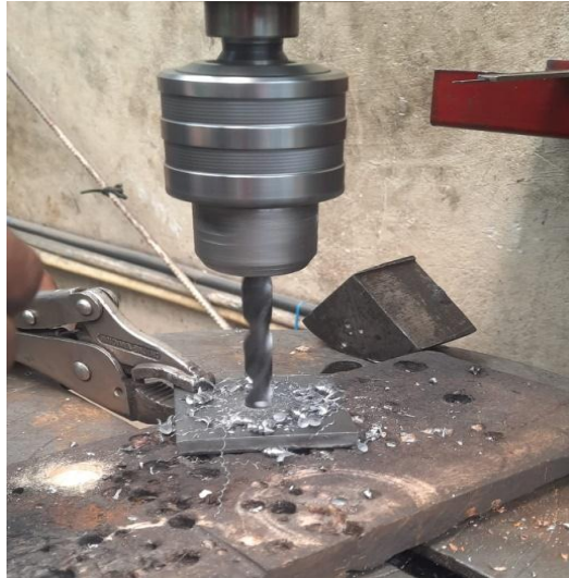
Ilustración 3-40: Perforación de las placas del soporte base con taladro de pedestal.
