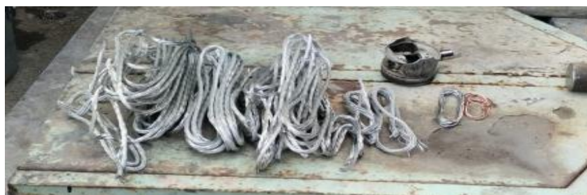
Ilustración 4-1: Disposición de materiales para fundición del aluminio.
