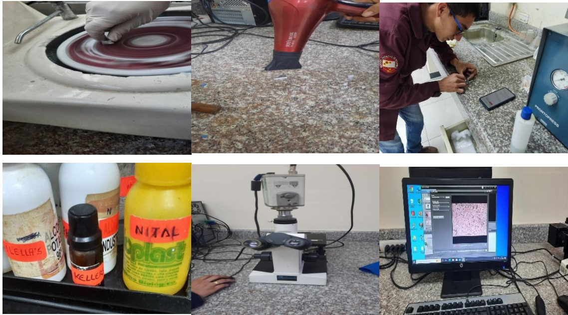
Ilustración 4-15: Proceso de ensayo de micrografía.
