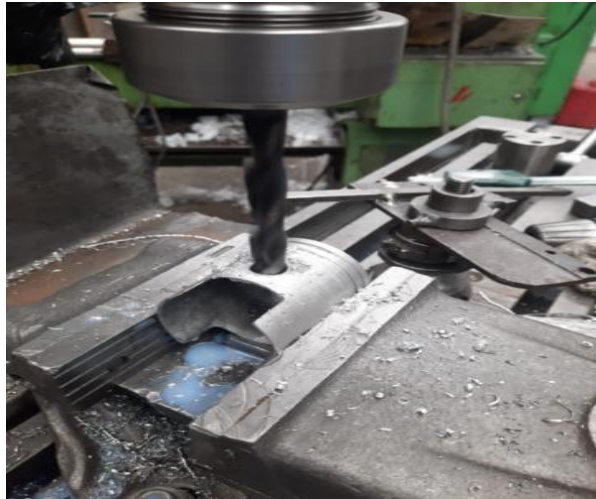
Ilustración 4-12: Mecanizado del pistón con ranurado de alojamiento para anillos.
