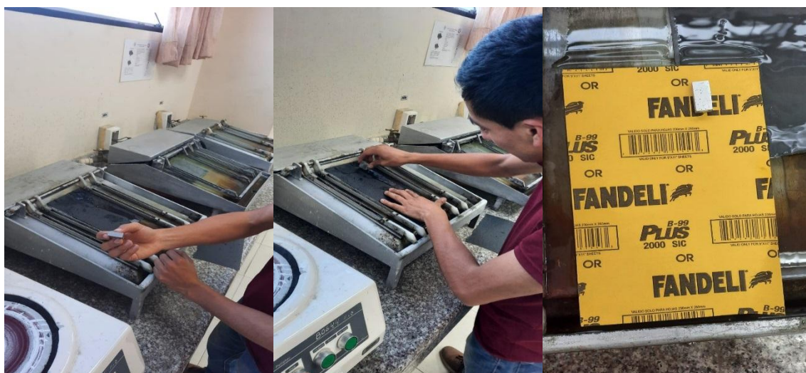
Ilustración 4-14: Proceso de desbaste con lija sobre probeta de pistón fundido.
