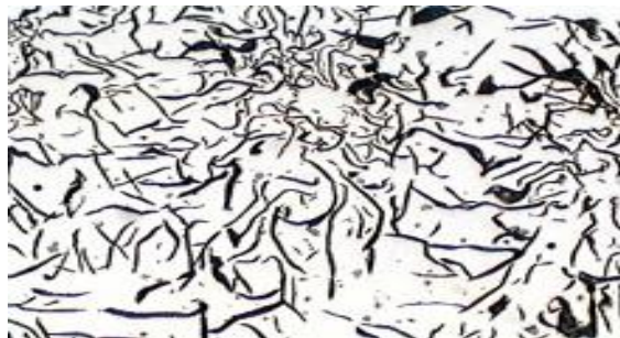
Ilustración 2-1: Fundiciones grises con estructura totalmente ferrítica.
