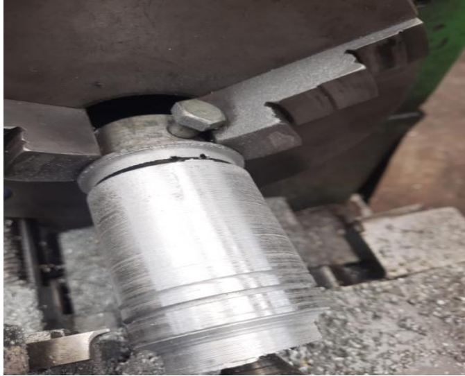
Ilustración 4-11: Mecanizado del pistón con ranurado de alojamiento para anillos.
