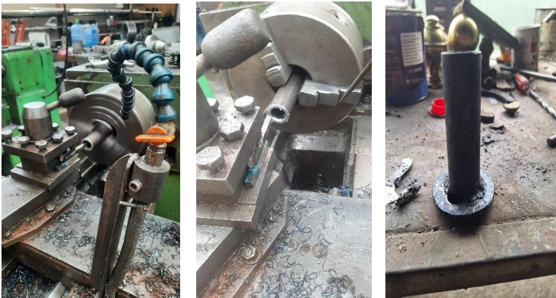
Ilustración 3-42: Mecanizado del eje hueco de 1" para el bebedero.
