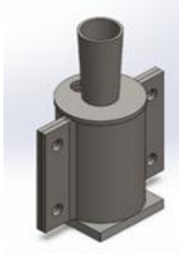
Ilustración 3-11: Ilustración de recreación del molde con integración de piezas del pistón.
