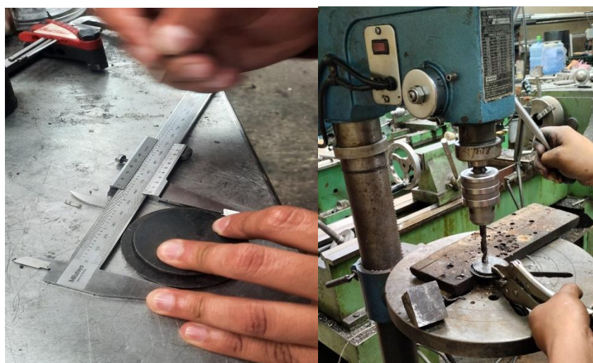
Ilustración 3-43: Perforación de los soportes superiores.
