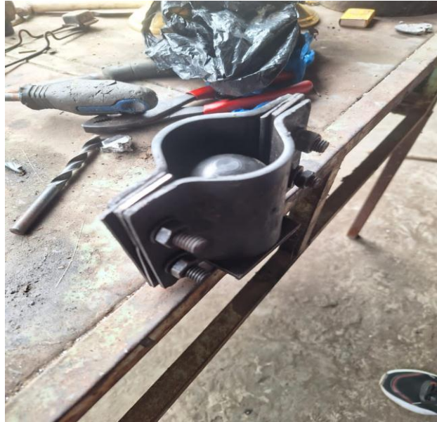
Ilustración 3-30: Unión de placa base con el molde.
