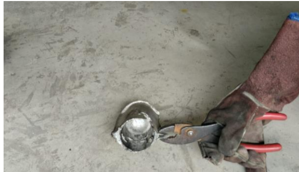
Ilustración 4-9: Remoción del bebedero del molde.
