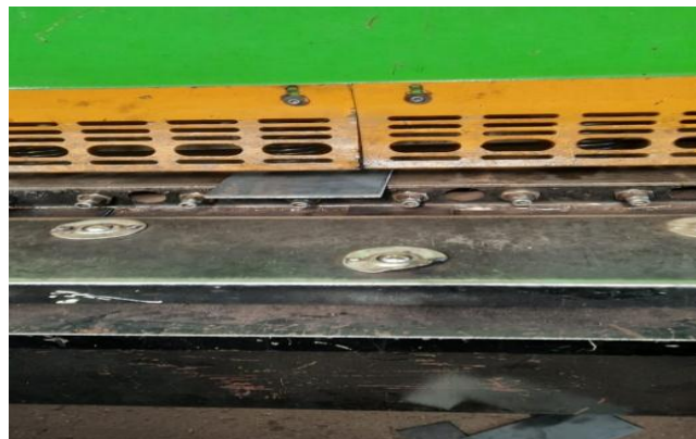
Ilustración 3-47: Proceso de corte de la placa base.
