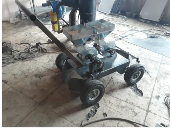
Ilustración 3-6: Sembradora con dosificación automática
