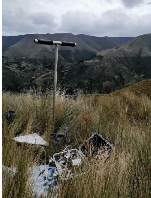
Ilustración 23-3: Perforación del suelo
