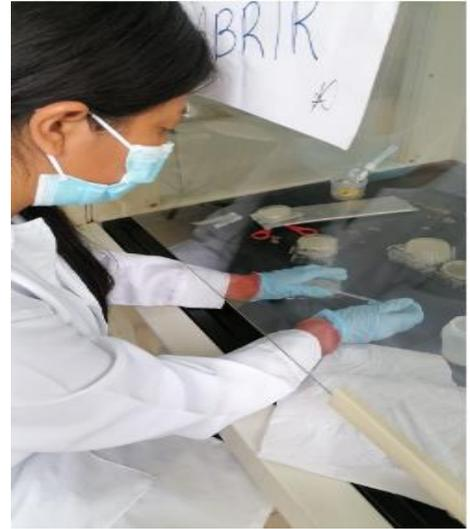
Siembra en cajas compact dry de coliformes fecales y totales - Laboratorio de Calidad del Agua ESPOCH.
