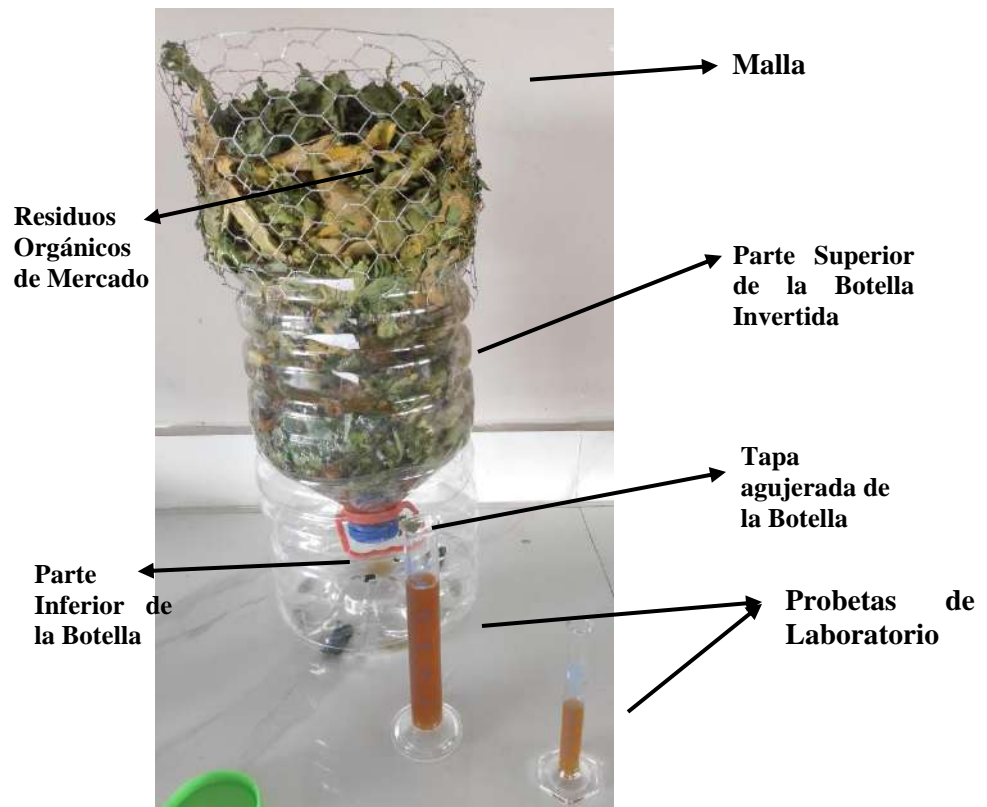
Gráfico 1-3: Equipo improvisado de determinación de lixiviación de residuos de mercado.
