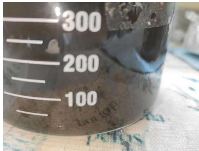
Gráfico 3-3: Separación Matriz líquida y sólida mediante coagulación floculación en biol.
