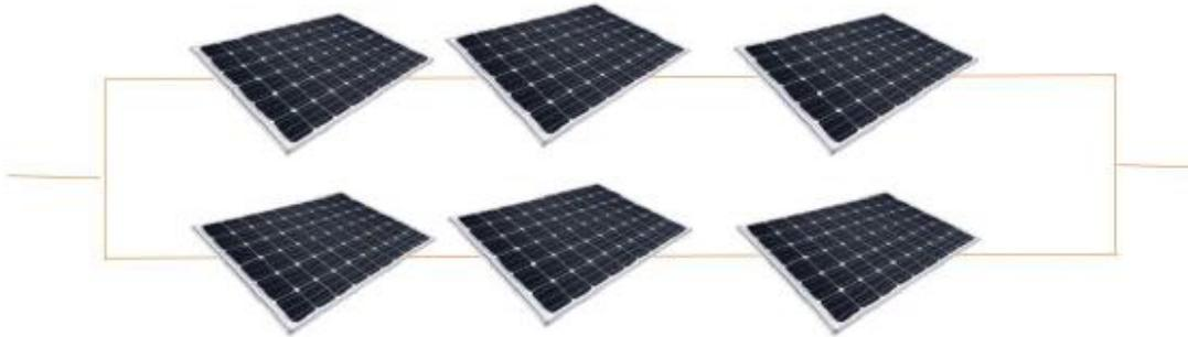
**Ilustración 2-9:** Conexión de paneles solares en paralelo
