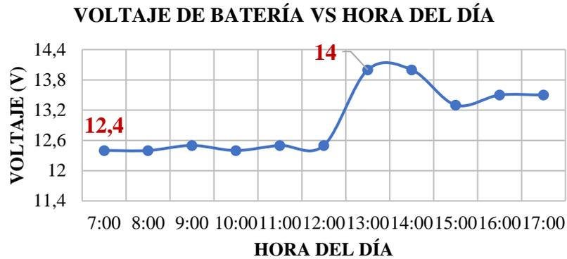
**Ilustración 4-20:** Voltaje de la batería en un día soleado
