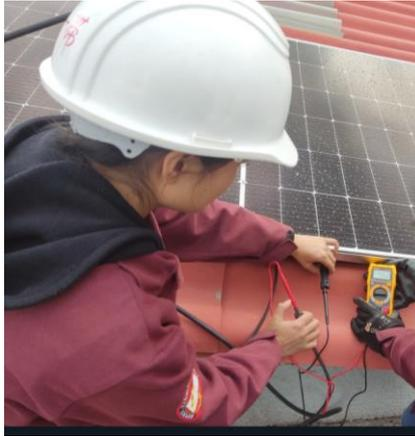
**Ilustración 3-6:** Comprobación del funcionamiento del panel solar
