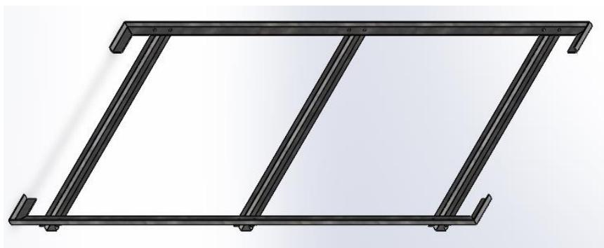
**Ilustración 3-5:** Base del panel solar
