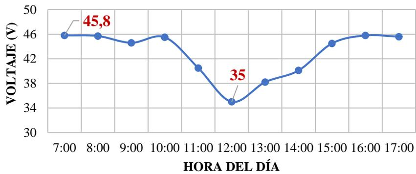
**Ilustración 4-22:** Voltaje de panel solar en un día nublado
