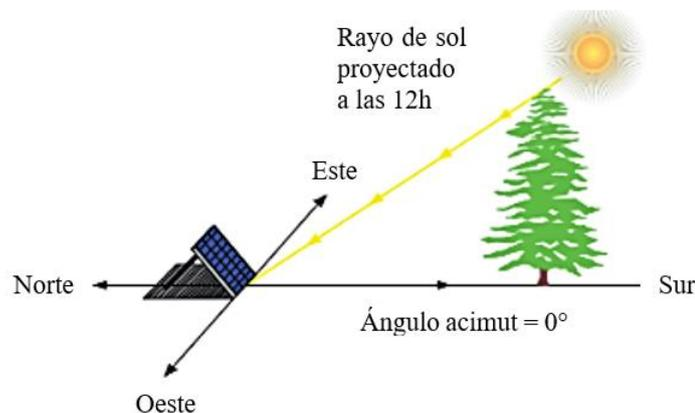
**Ilustración 2-19:** Posición correcta de paneles solares
