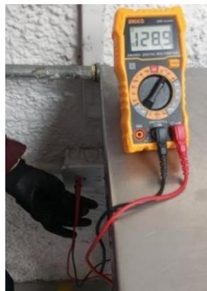
**Ilustración 4-14:** Medición de voltaje en tomacorrientes
