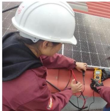
**Ilustración 4-16:** Medición del voltaje en circuito abierto del panel solar
