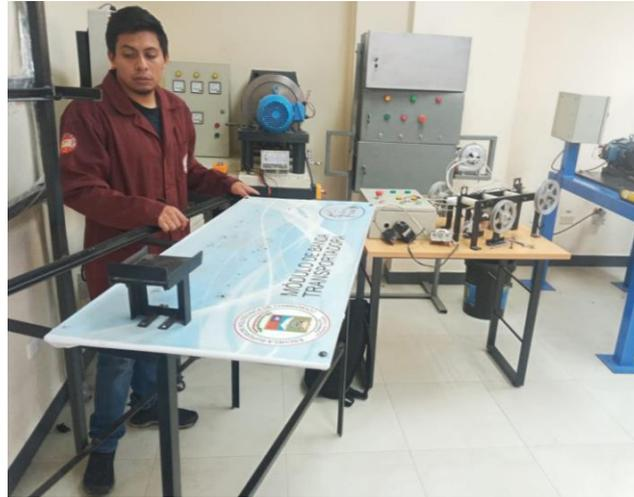
**Ilustración 3-21:** Desmontaje del módulo de banda transportadora
