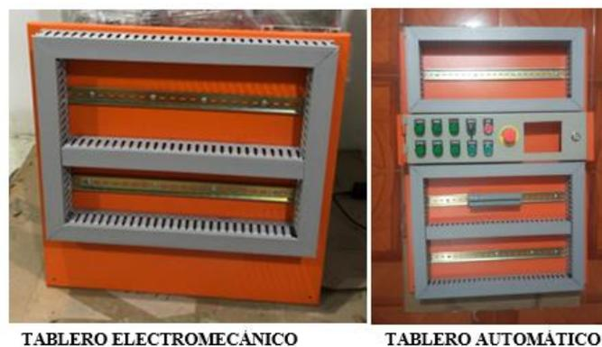
**Ilustración 3-23:** Instalación de canaletas y rieles DIN
