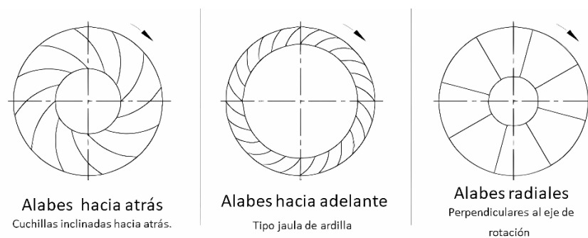
Ilustración 2-7: Álabes de los tipos de ventiladores centrífugos.
