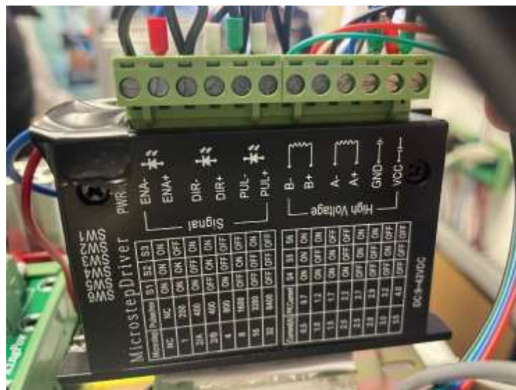
Ilustración 3-5: Controlador TB6600 de motores a paso.
