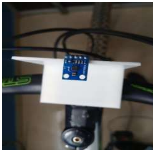
Ilustración 3-17: Implementación física del sensor GY-273 con el soporte en la bicicleta
