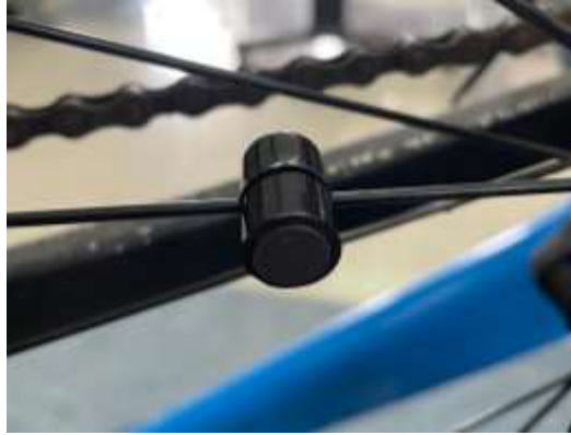
Ilustración 3-16: Imán para la detección por efecto Hall.
