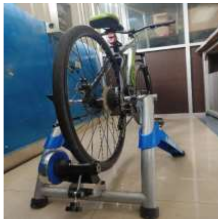
Ilustración 3-15: Acople de la bicicleta con el rodillo ciclo simulador
