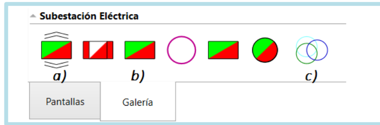
Ilustración 3-35: a) Interruptor extraíble, b) Interruptor, c) Trafo. Realizado por: Zamora A., Zavala K., 2023.
