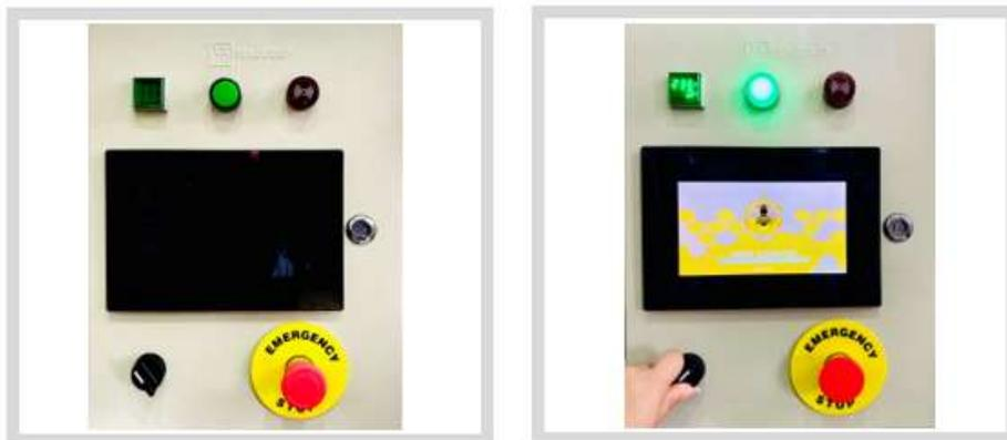
**Ilustración 4-17:** Encendido del extractor de miel automatizado.
