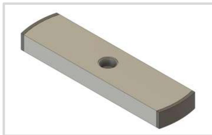
**Ilustración 3-26:** Diseño del soporte del motor eléctrico
