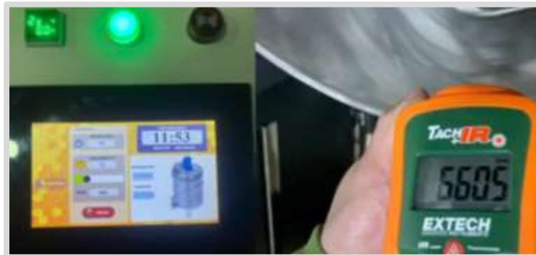
**Ilustración 4-11:** Evidencia de las muestras tomadas del controlador de velocidad digital en el HMI junto al tacómetro
