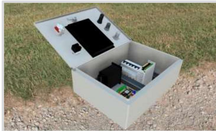
**Ilustración 3-31:** Estructura implementada del panel de control
