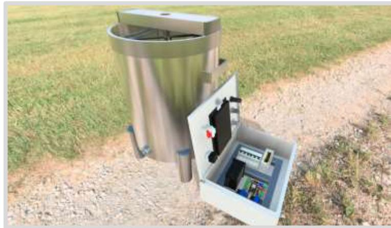
**Ilustración 4-1:** Extractor de miel automatizado
