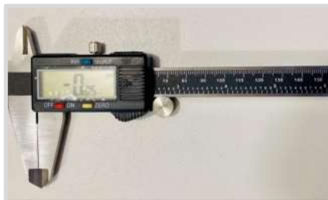
**Ilustración 4-6:** Calibrador digital *Neiko*
