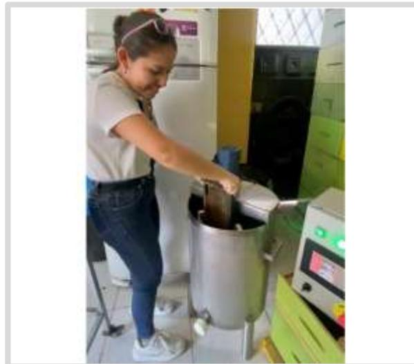
**Ilustración 4-15:** Introducción de marcos en el extractor de miel automatizado
