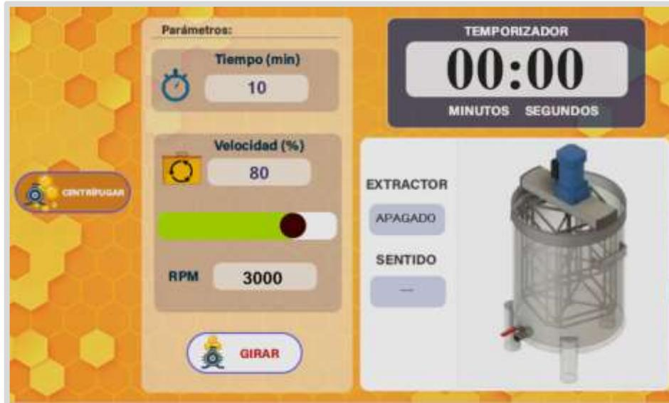
**Ilustración 3-23:** Diseño de la ventana de centrifugado de la pantalla Nextion
