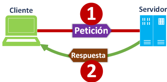
Figura 9-2: Modelo de alto nivel de cliente y servidor
