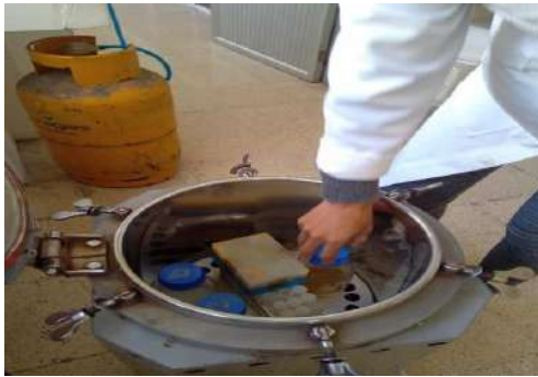
E1. Colocación de los medios de cultivo en la autoclave para su esterilización.
