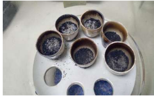
D4. Regulación de temperatura de las muestras en el desecador
