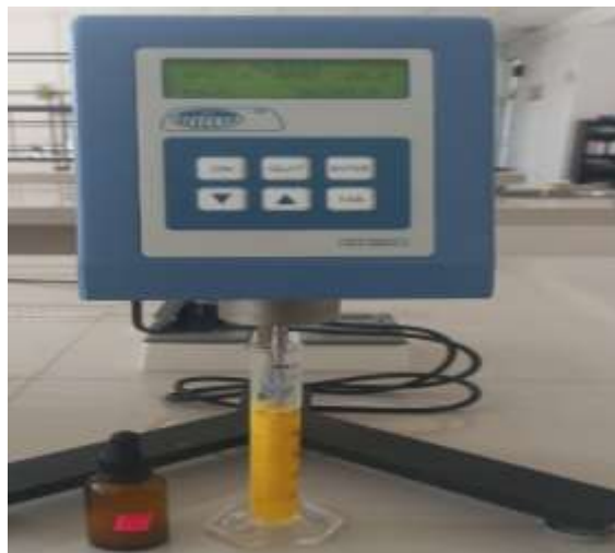
Ilustración 2-7: Viscosímetro para las muestras de serum a partir del aceite de aguaje
