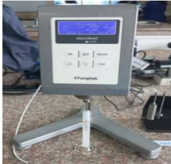
Ilustración 2-6: Viscosímetro para las muestras de serum a partir del filtrado del fermento de galactomyces
