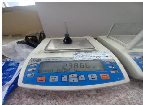
Fotografía N°6. Peso de picnómetro con agua y CATi
