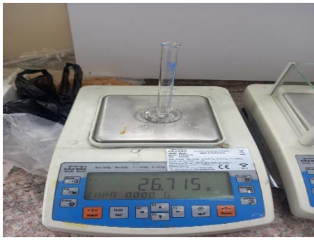
Fotografía N°1. Peso de probeta vacía
