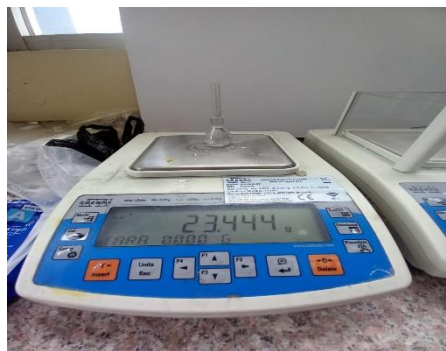
Fotografía N°7. Peso de picnómetro con agua
