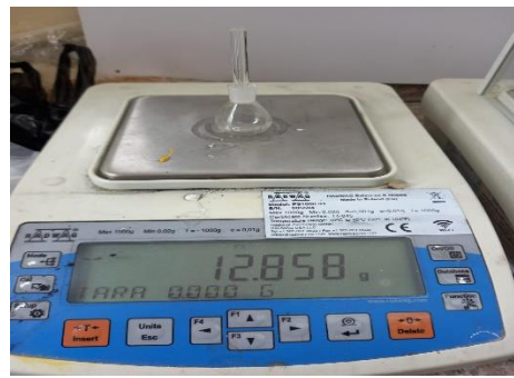
Fotografía N°4. Peso de picnómetro vacío
