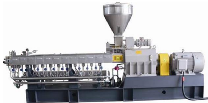
Ilustración 2-2: Extrusor de tornillo gemelo
