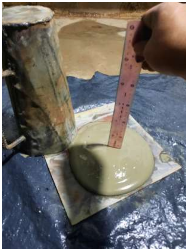
Ilustración 3-33: Segunda prueba de Slump en mezcla 2:1.
