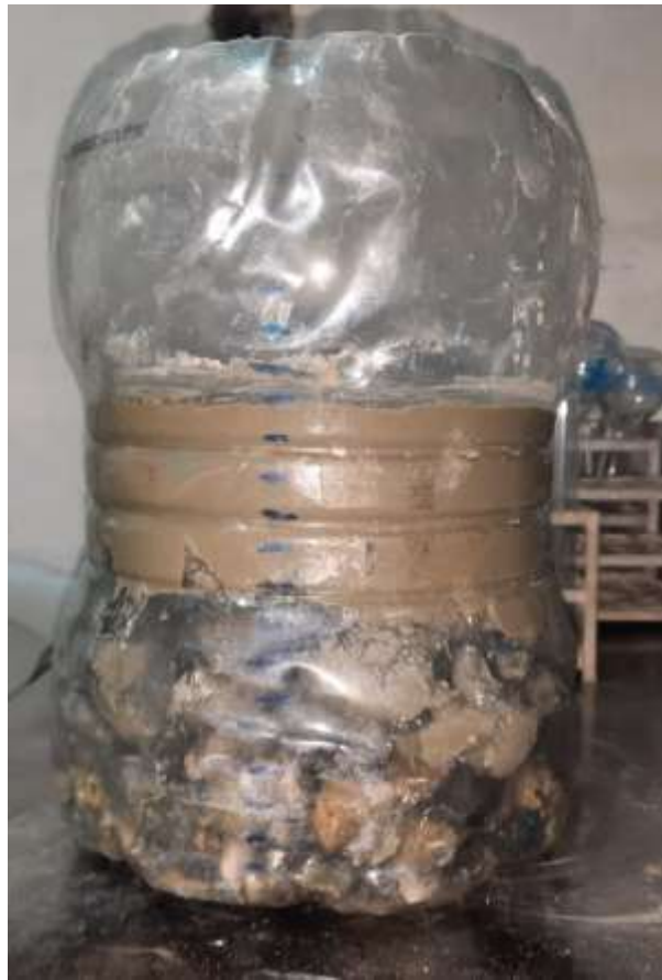
Ilustración 3-28: Filtración casi nula de mezcla 2:1.
