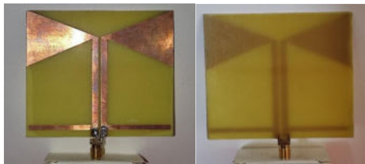
Ilustración 3-4: Antenas implementadas transmisora y receptora.
