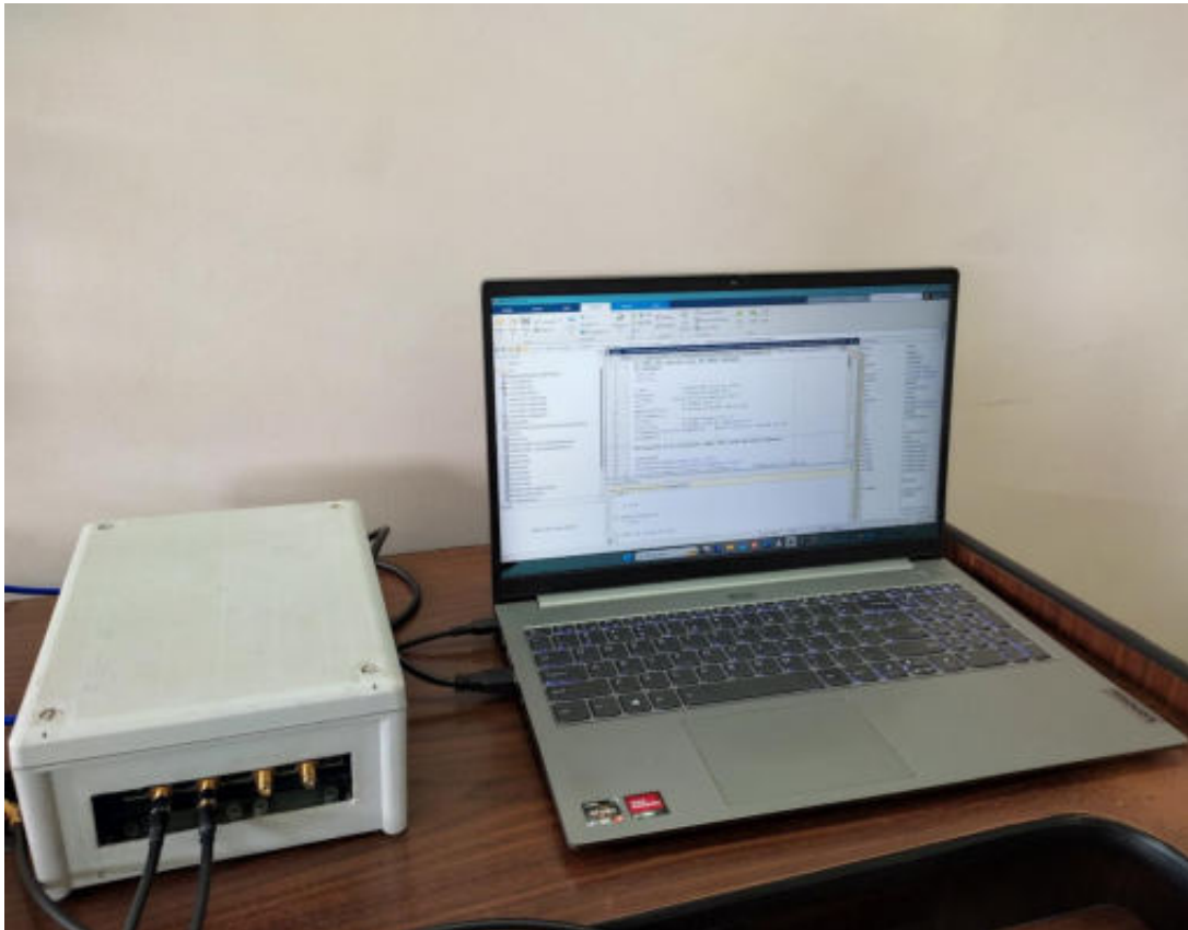
Ilustración 4-1: Conexión física entre la laptop y la tarjeta USRP B210
