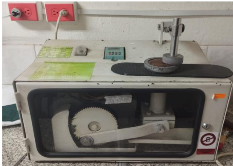
Ilustración 3-3: Equipos para la medición de abrasión al frote (ciclos).
