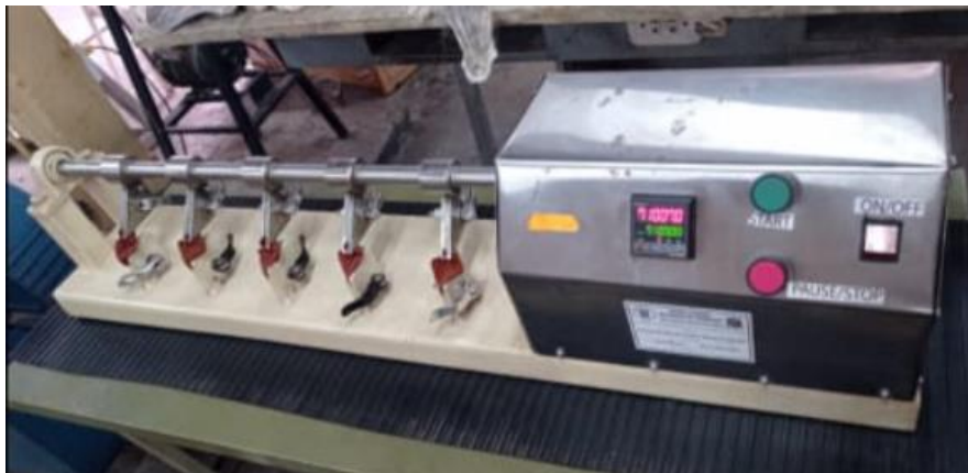
Ilustración 7-3: Equipo de análisis de resistencia a la flexión.
