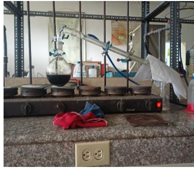
Destilación del ácido acético
