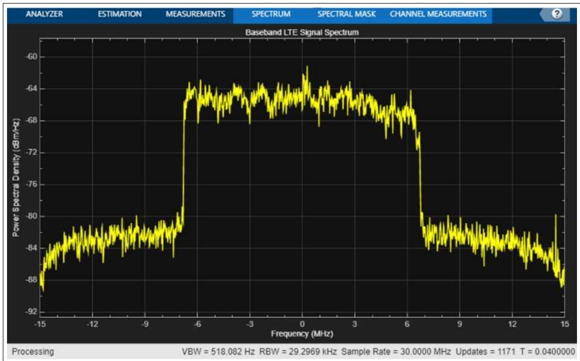
Ilustración 4-2: Señal LTE recibida por la USRP B210 en función de potencia y frecuencia en frecuencia central de 795.5 MHz.
