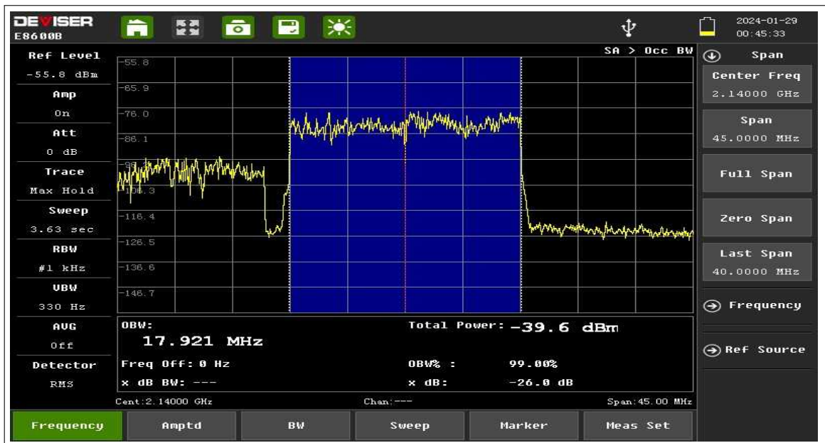
Ilustración 4-34: Medida de la red LTE en f_c=2140 MHz
