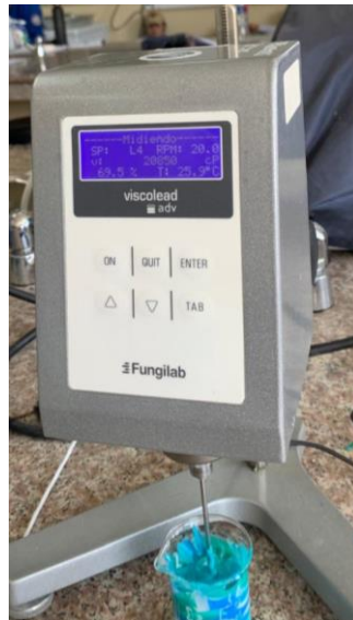
Ilustración 9: Determinación de viscosidad de la pasta patrón a 20 850 cP
