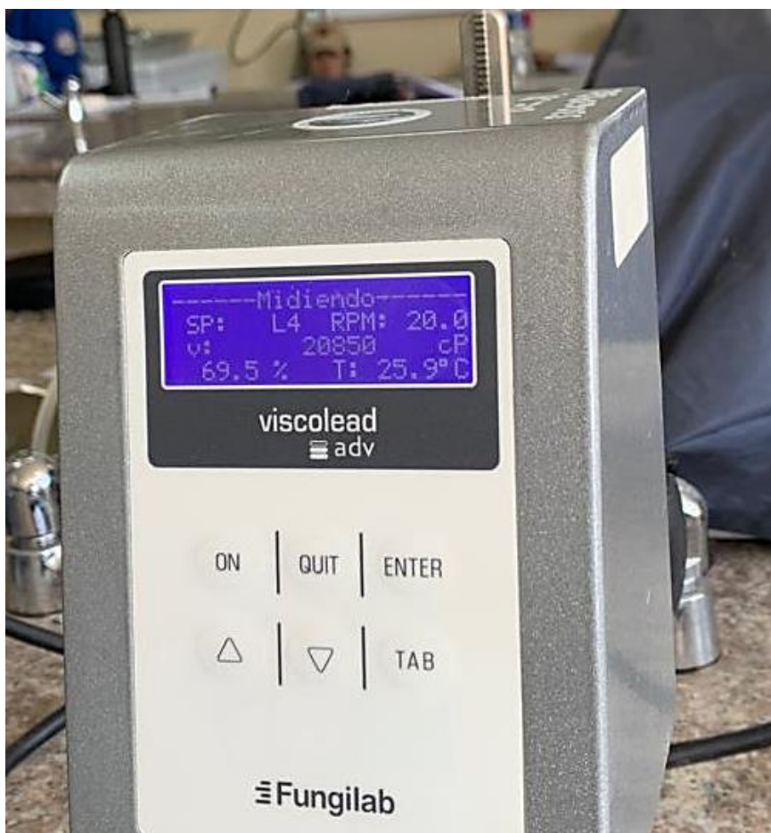
Ilustración 3-2: Pasta patrón con una viscosidad de 20 850 cP a 20 RPM
