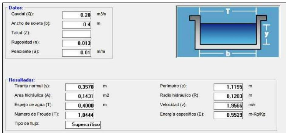
**Ilustración 4-6:** Sección transversal diseño Subdrenaje
