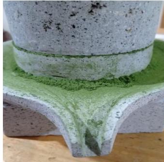
Ilustración 2-4: Molino de piedra de granito
