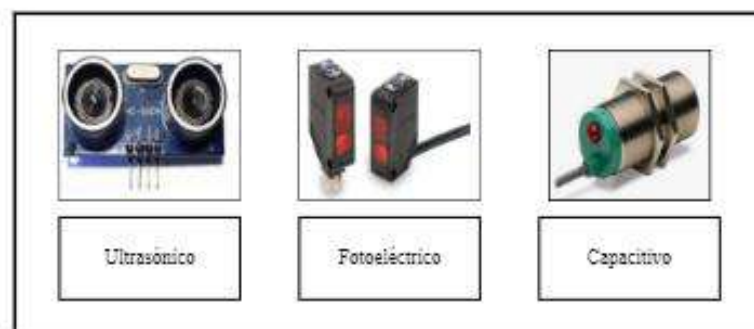
Ilustración 3-36: Características de sensores de detección
