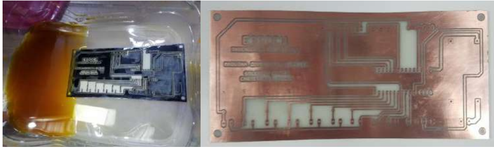
Ilustración 3-62: Ataque de ácido a placa electrónica. Realizado por: Lasluisa D., Lozada C.,2023
