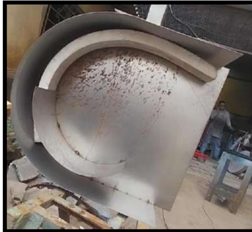
Ilustración 3-60: Construcción de Acople Realizado por: Lasluisa D., Lozada C.,2023
