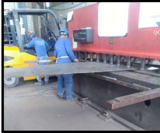
Ilustración 3-51: Corte por guillotina de estructura principal Realizado por: Lasluisa D., Lozada C.,2023
