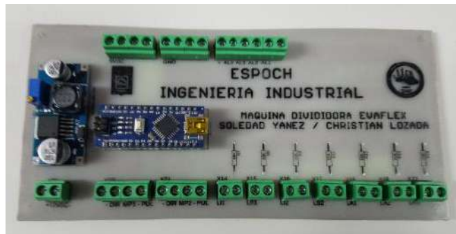
Ilustración 3-64: Placa electrónica PCB implementada. Realizado por: Lasluisa D., Lozada C.,2023
