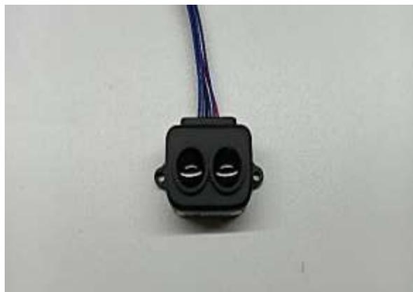
**Ilustración 3-8:** Microsensor de rango LiDAR TF-Luna (ToF)
