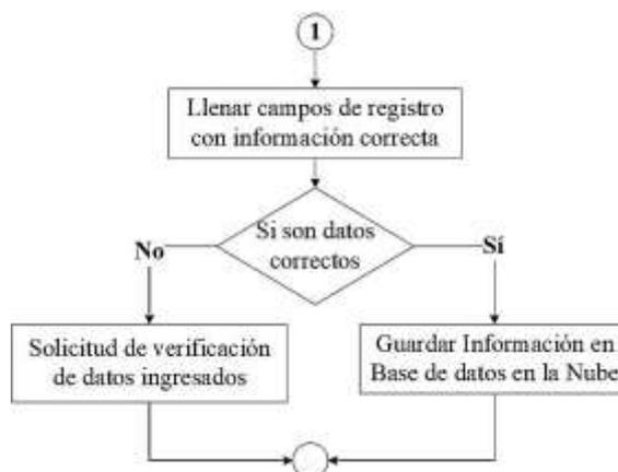
**Ilustración 3-26:** Diagrama de flujo del registro de usuario
