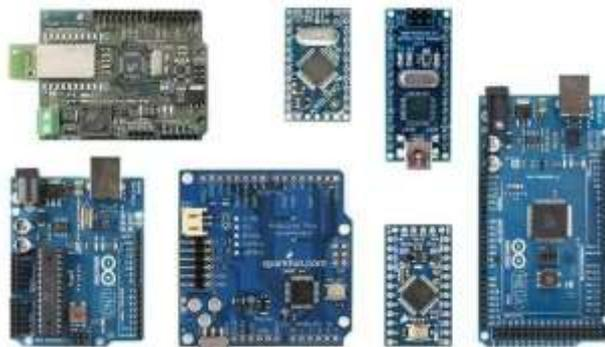
**Ilustración 2-24:** Tarjetas Arduino
