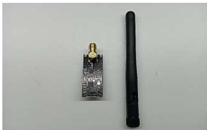
**Ilustración 3-6:** Módulo RF 2.4GHZ - NRF24L01+PA+LNA con antena
