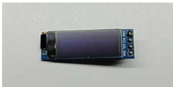
**Ilustración 3-7:** Display OLED 0.91" I2C 128\*32 SSD1306
