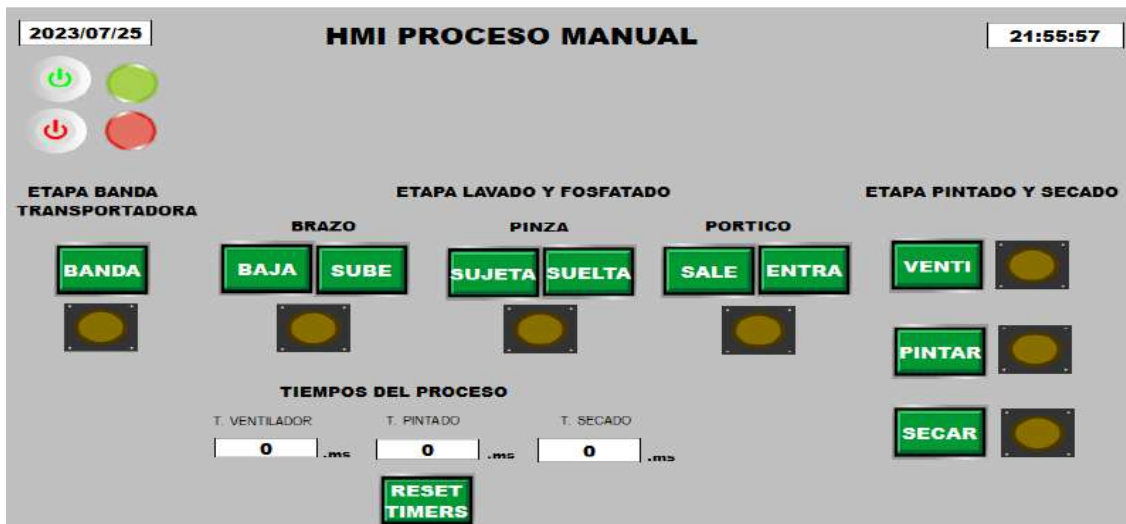
Ilustración 3-63: Pantalla de funcionamiento manual del módulo.
