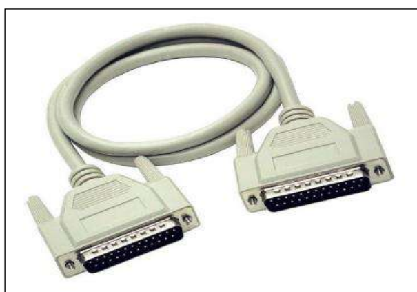
Ilustración 3-30: Cable de comunicación DB25.
