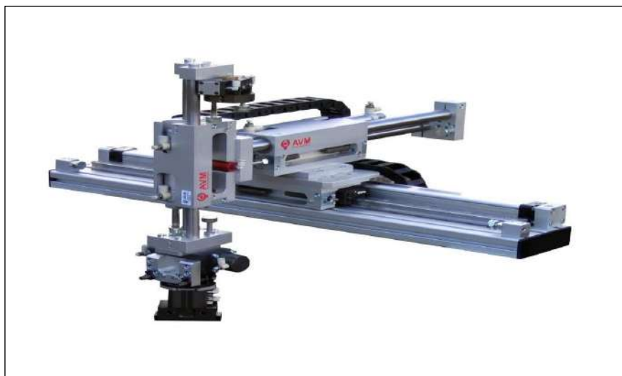
Ilustración 2-9: Manipulador neumático Y-Z pick and place.
