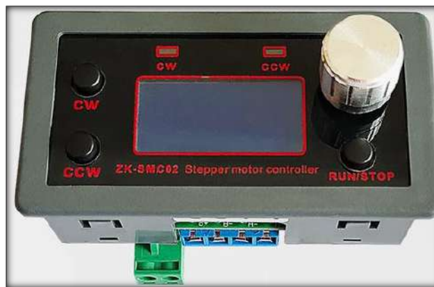
Ilustración 3-19: Generador de pulsos PWM ZK-SMC02
