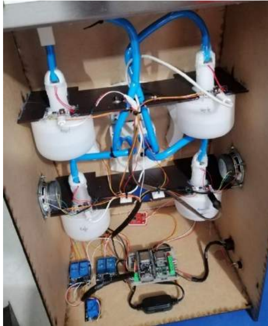
Ilustración 3-30: Construcción y ensamblaje del módulo de olores
