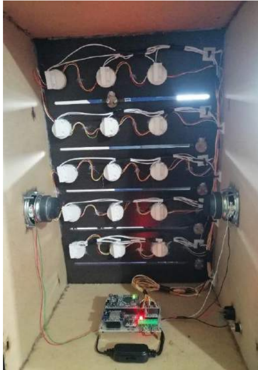
Ilustración 3-24: Construcción y ensamblaje del módulo rutas musicales
